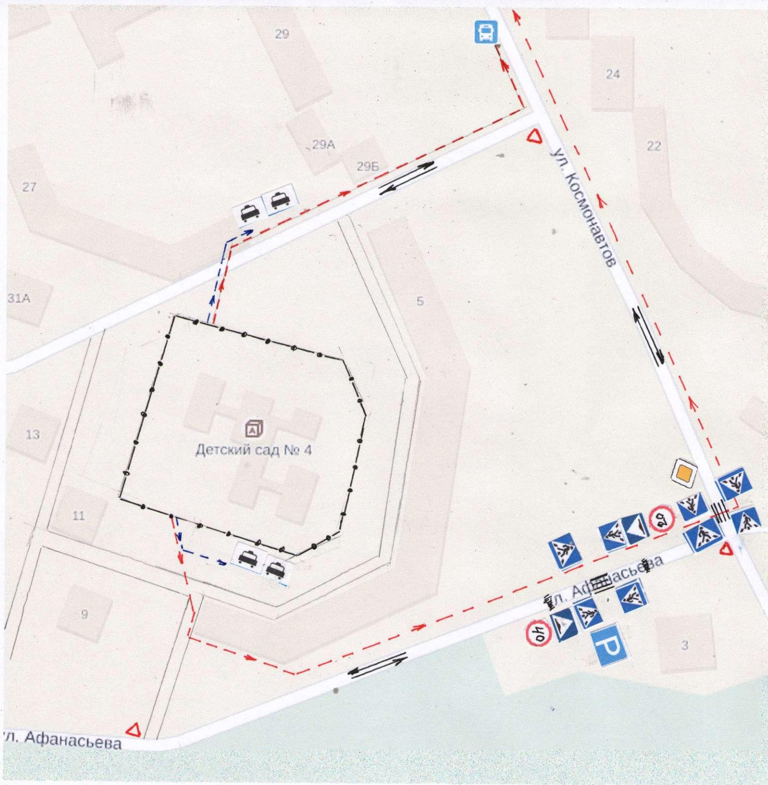
Схема организации дорожного движения в непосредственной близости от детского сада с размещением соответствующих технических средств, маршруты движения детей и расположение парковочных мест
